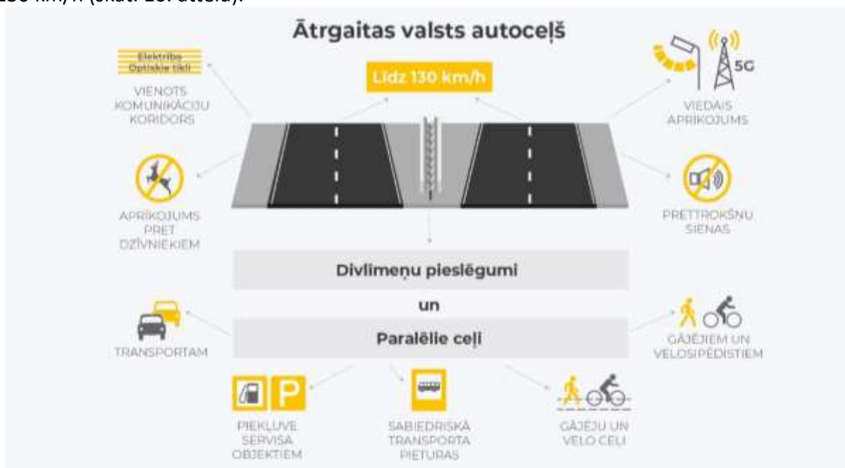
10. attēls. Plānoto divu brauktuvju ātrgaitas autoceļu risinājums
