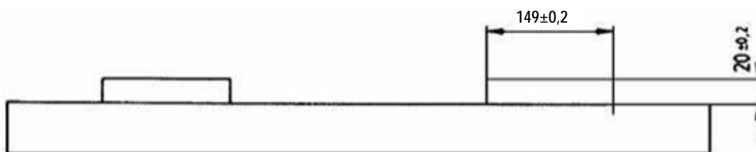
3. attēls. Plātnes shematiskais attēlojums ar uzmontētiem cilindriskiem diskam
