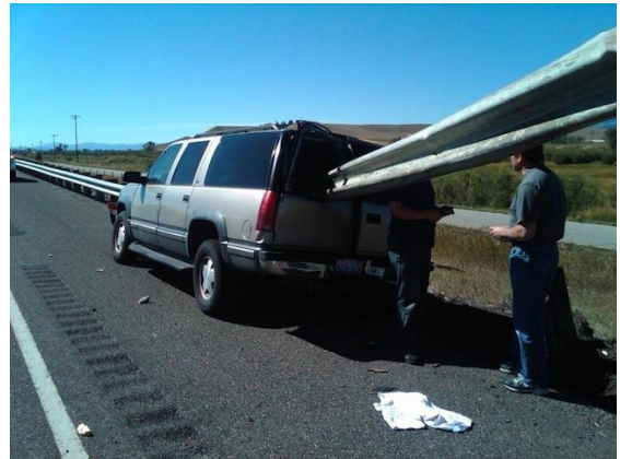
2-15. att. Barjeras garenvirziena elementa ieduršanās transportlīdzekļa salonā
