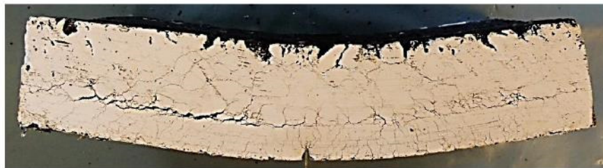
Pastiprināts paraugs ar ģeokompozītu pēc 155 000 pārbraucienų skaita (Noguruma plaisu veidošanās > 3.7)
