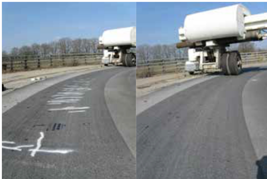
3-6.35. Nepastiprinātais un pastiprinātais posms testa beigās [61]
