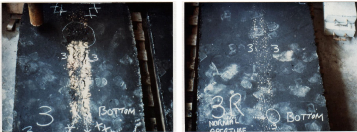
3-6.11. attēls. Nepastiprinātais slānis (pa kreisi) un pastiprinātais slānis (pa labi) [48]
