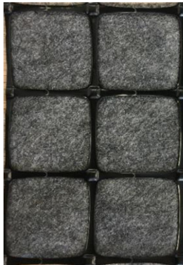
3-7.9. Attēls. Augsta profila monolīts divasu ģeorežģis rūpnieciski savienots ar ģeotekstilu (atvēruma izmērs 65x65mm) [48]
