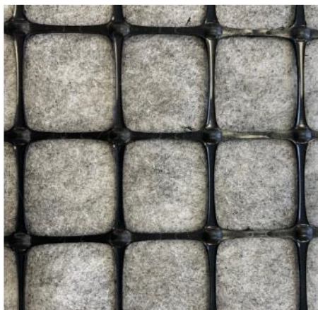
3-4.7. attēls. Augsta profila monolīts divasu ģeorežģis rūpnieciski savienots ar ģeotekstilu.
