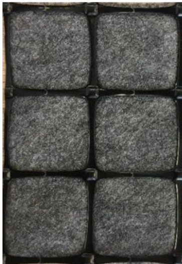
3-7.1. Augsta profila monolīts divasu ģeorežģis rūpnieciski savienots ar ģeotekstilu (atvēruma izmērs 65x65mm) [48]
