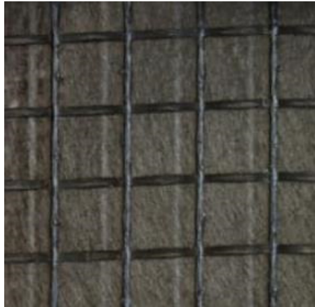
3-4.6. attēls. Zema profila ģeorežģi rūpnieciski savienoti ar ģeotekstilu.
