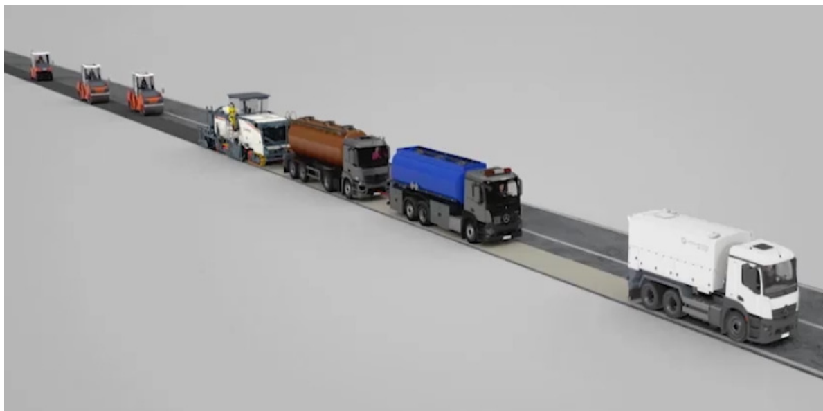
4-3.9. attēls. Rekomendētais reciklēšanas mašīnu sastāvs, materiālu stabilizējot ar cementu un bitumenu vai putu bitumenu [36]
