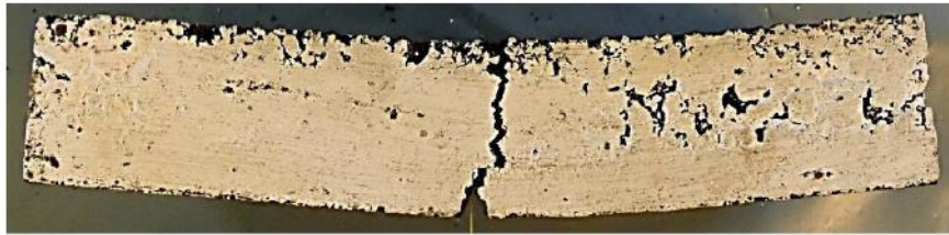
Nepastiprināts paraugs pēc 41 000 pārbraucienų skaita
