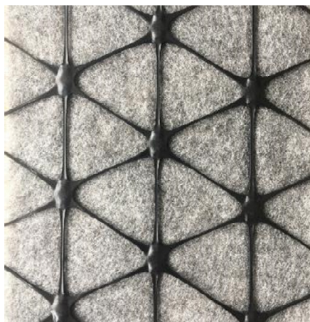
3-4.8. attēls. Augsta profila monolīts trīsas (sešstūra) ģeorežģis rūpnieciski savienots ar ģeotekstilu.
