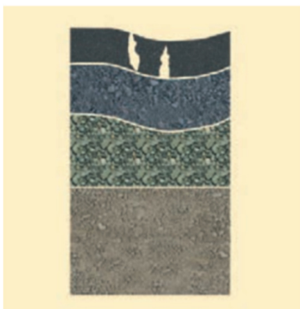
4-1.2. attēls. Seguma bojājumu dziļums pārsniedz ~20 cm , ir fiksēti būtiski strukturāli bojājumi un deformācijas. Nepieciešama pārbūve [34]
