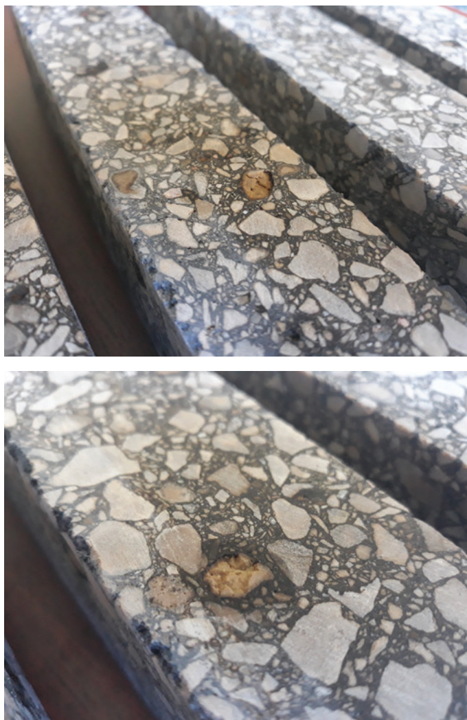
62. att. Asfaltbetona maisījumu paraugi pēc 100 sasaldēšanas un atkausēšanas cikliem
