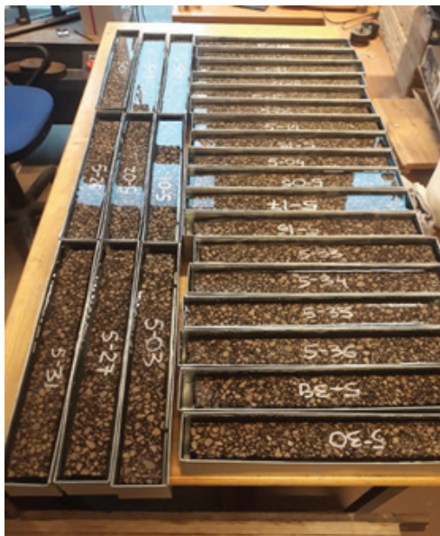
58. att. Asfaltbetona paraugu piesātināšana ar 3% NaCl ūdens šķīdumu, izturot tajā pirms sasaldēšanas
