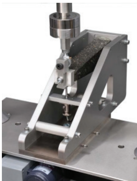
6. attēls. Divu punktu lieces testa iekārta trapeces formas paraugiem [8]
