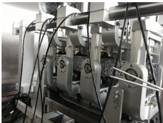
9. att. Četru punktu lieces testa paraugu slogošanas sistēma
