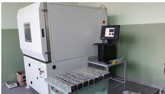
10. att. Četru punktu lieces testa kamera un paraugi (sijas)
