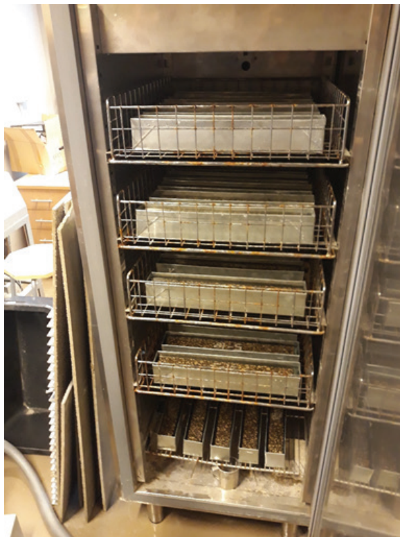
59. att. Paraugu novietojums sasaldēšanas/atkausēšanas kamerā
