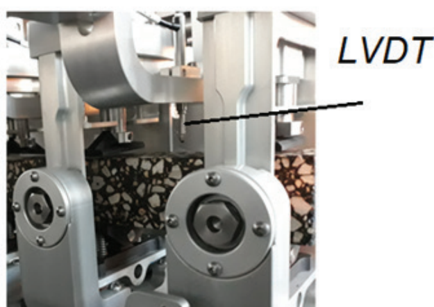
17. att. Sensoru LVDT izvietojums deformācijas mērīšanai
