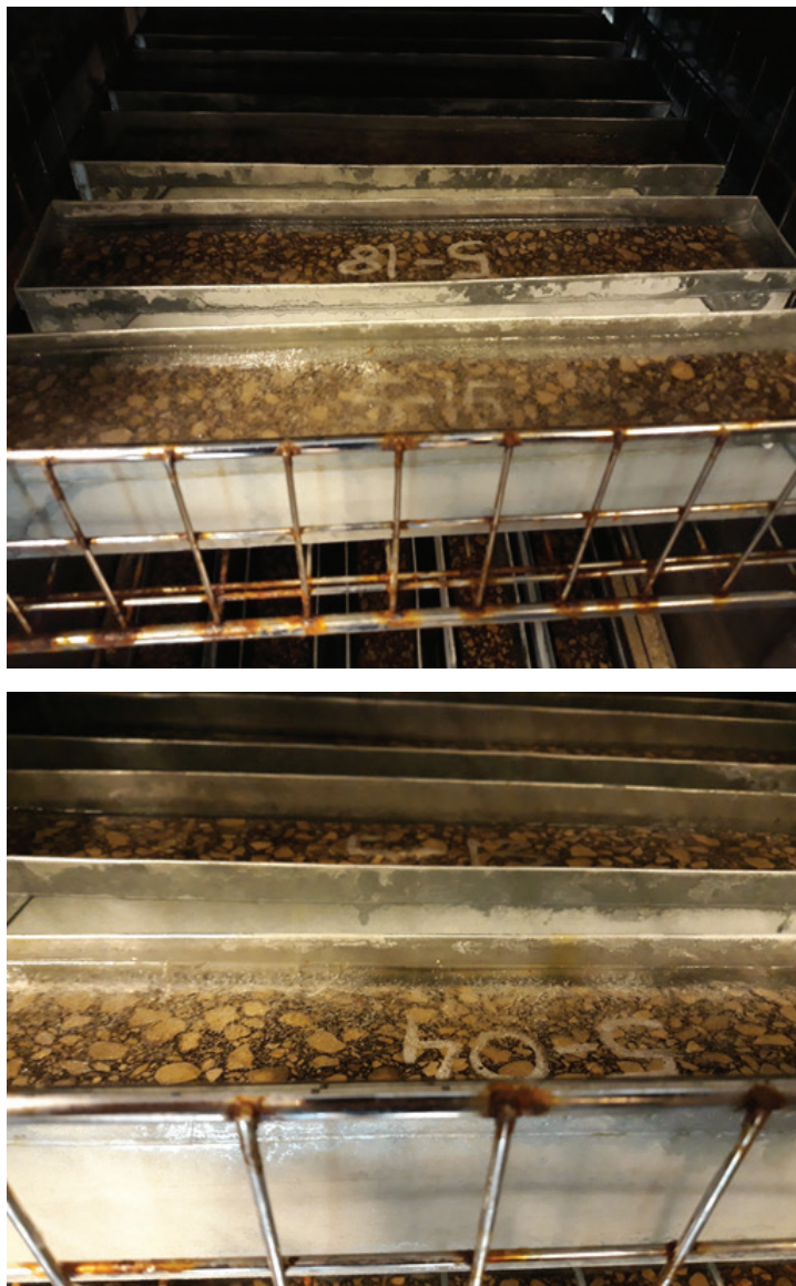
60. att. Paraugu stāvoklis ūdens vidē – 3% NaCl ūdens šķīdumā sasaldēšanas laikā
