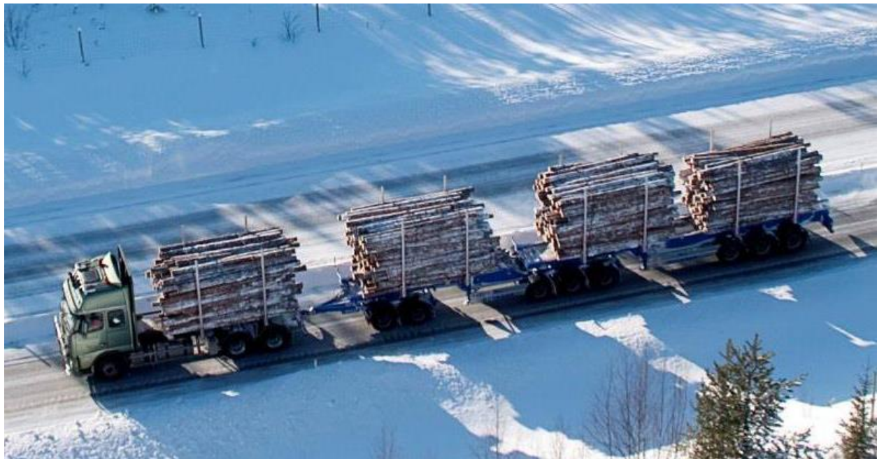
3.2.att. Modulārā transporta sistēma, kravas garums 30 m un svars 90 t (foto no (Kharrazi,S., Karlsson,R., Sandin,J., Aurell,J., 2015)).
