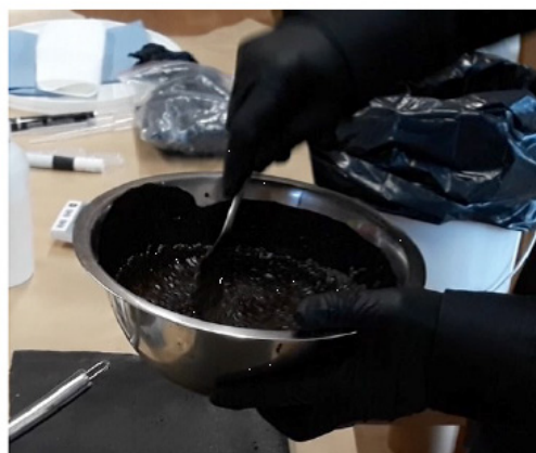
66. att. Bitumena emulsijas pievienošana (a) un maisīšana noteiktu laiku, kurš jāuzņem (b)
