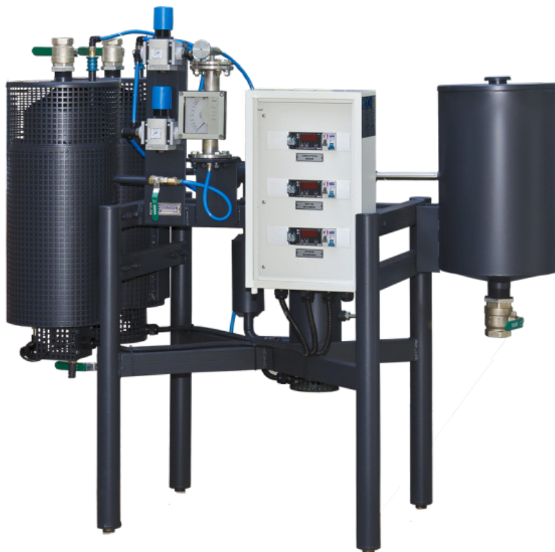
60. att. Laboratorijas iekārta bitumena emulsijas izgatavošanai
