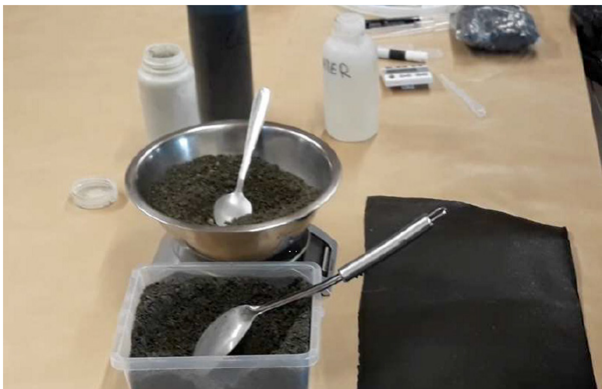
64. att. Portlandcimenta un sīkšķembu sajaukšana
