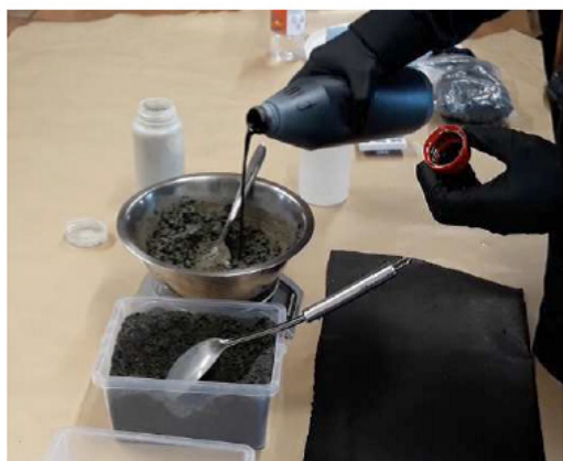
66. att. Bitumena emulsijas pievienošana (a) un maisīšana noteiktu laiku, kurš jāuzņem (b)
