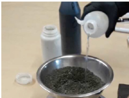
65. att. Ūdens pievienošana (a) un maisīšana (b)
