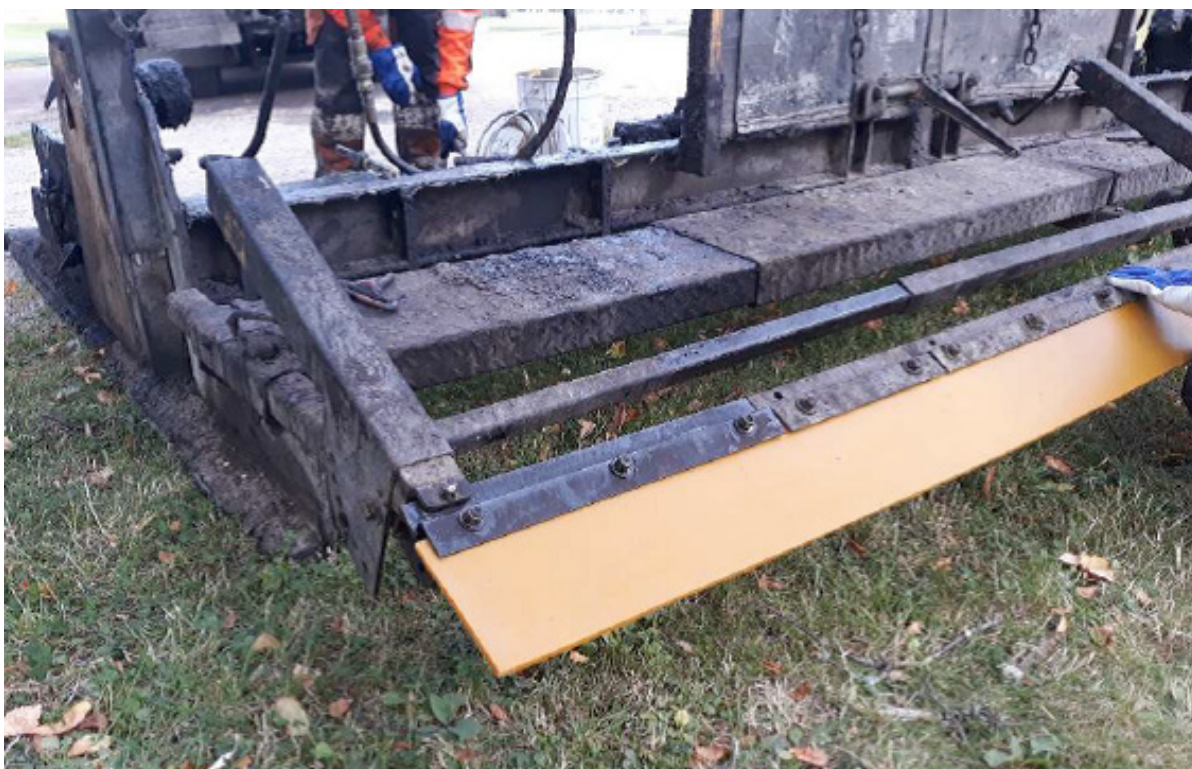
35. att. Izlīdzināšanas gumijas lentes piestiprināšana pie kastes
