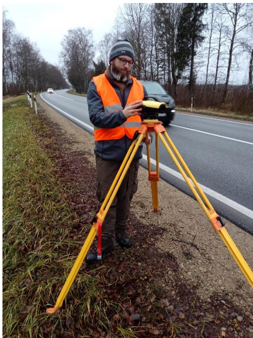
5. attēls. Monitoringa punktu nivelēšana (attēls pa kreisi) un ģeogrāfiskā piesaiste ar reālā laika GNSS (pa labi).
