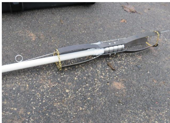
8.attēls. Urbuma nostiprinātā daļa ar PVC cauruli (pa kreisi) un ekstenciometra enkurs (pa labi).
