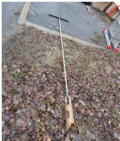
7. attēls. Ceļa uzbērumā izveidotais urbums (pa labi) un rokas urbis (pa kreisi).
