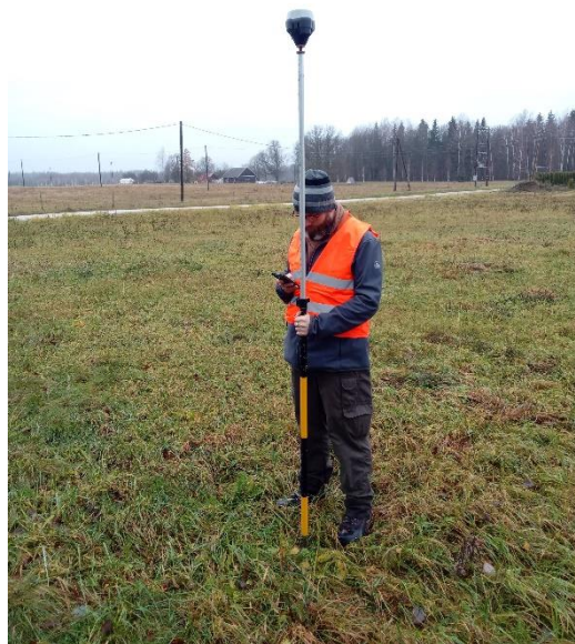
5. attēls. Monitoringa punktu nivelēšana (attēls pa kreisi) un ģeogrāfiskā piesaiste ar reālā laika GNSS (pa labi).
