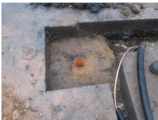
8.attēls. Urbuma nostiprinātā daļa ar PVC cauruli (pa kreisi) un ekstenciometra enkurs (pa labi).
