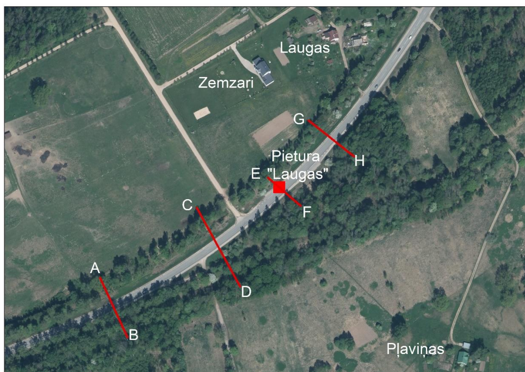
2. attēls. Priekšizpētes gaitā izvietotie ceļa šķēršprofili grāvju dziļuma un uzbēruma biezuma mērījumiem. Apzīmējumi: sarkanās līnijas – šķēršprofili; sarkanais kvadrāts – izvēlētā monitoringa vieta.
