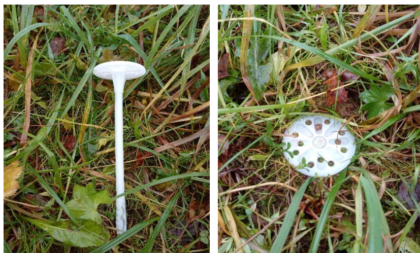
4. attēls. Pieguļošajā laukā izmantotie plastmasas dībeļi monitoringa punktu atzīmēšanai.
