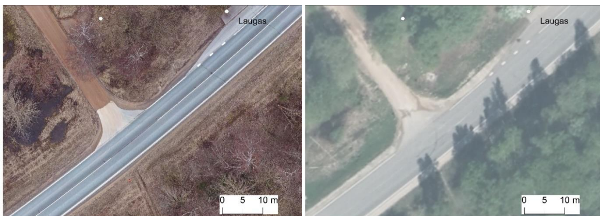
38. attēls. Ar bezpilota lidaparātu iegūtā ortofotokarte (pa kreisi) un 6. aerofotografēšanas cikla karte (pa labi).
