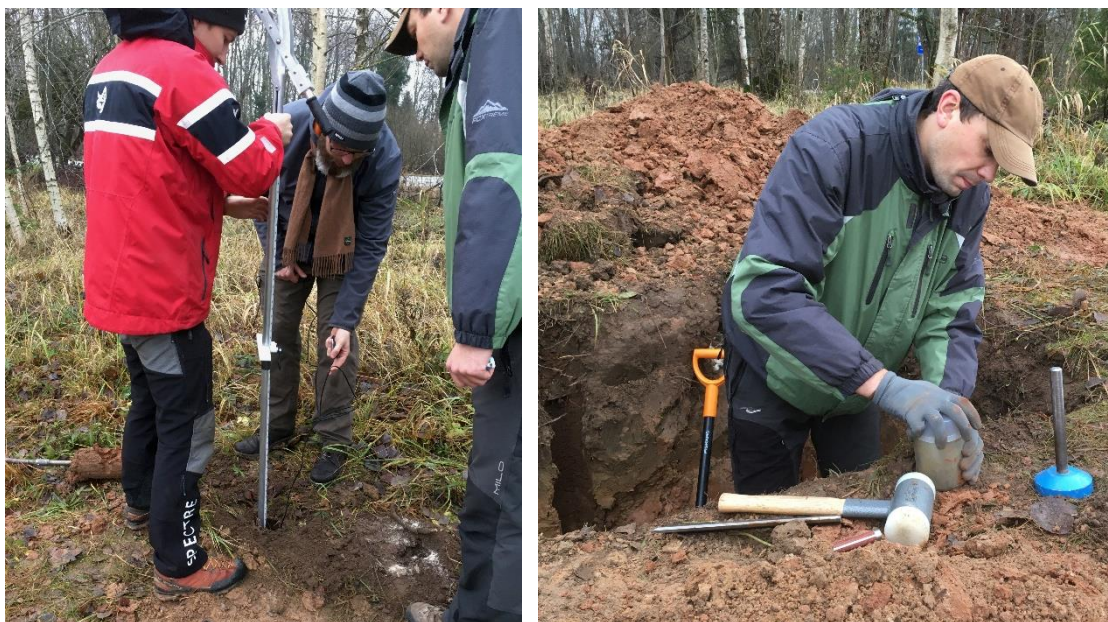
20. attēls. Sensoru ievietošanas iekārtas izmēģinājumi (pa kreisi) un grunts paraugu ņemšana laboratoriskajiem pētījumiem.
