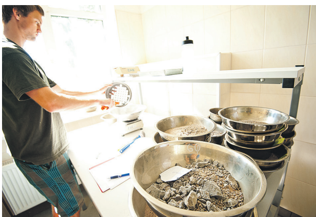
Visus paraugus nogādā Ceļu laboratorijā, kur tiek veikta granulometrija – sijājot tiek noteikts smalko un rupjo daļu īpatsvars.
