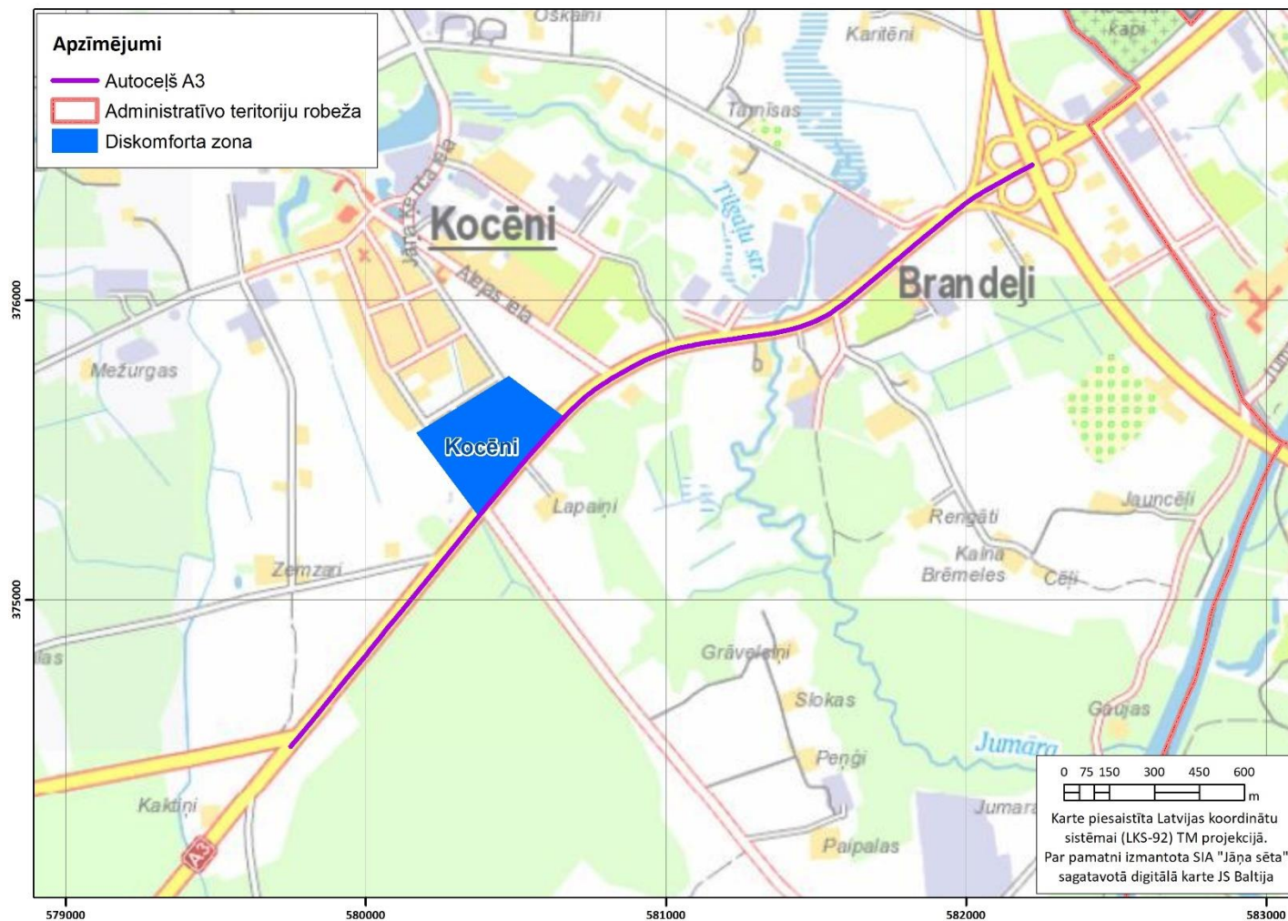
3. attēls. Akustiskā diskomforta zona autoceļa A3 Inčukalns – Valmiera – Igaunijas robeža (Valka) tuvumā
