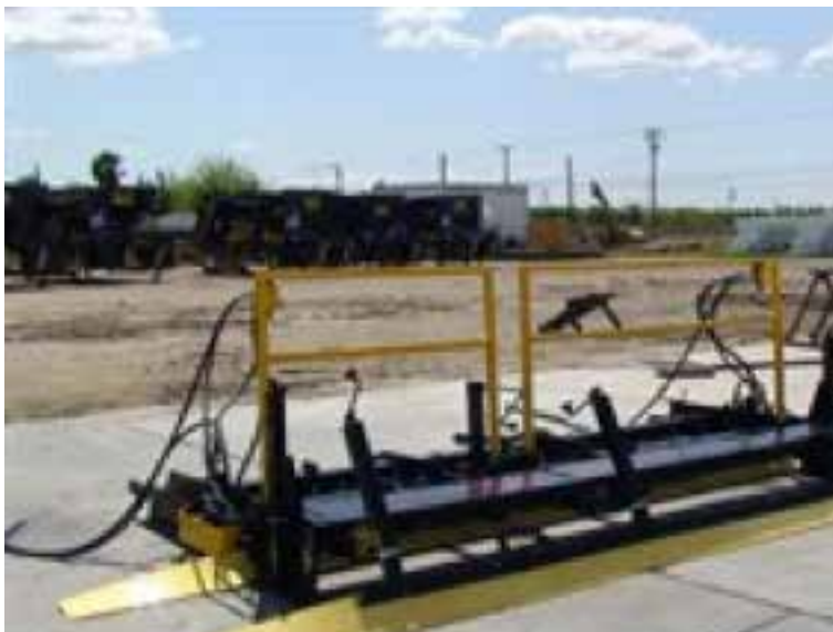
2.35.att. Microsurfacing ieklāšanas mašīnas maisījuma izkliešanas kaste [27]
