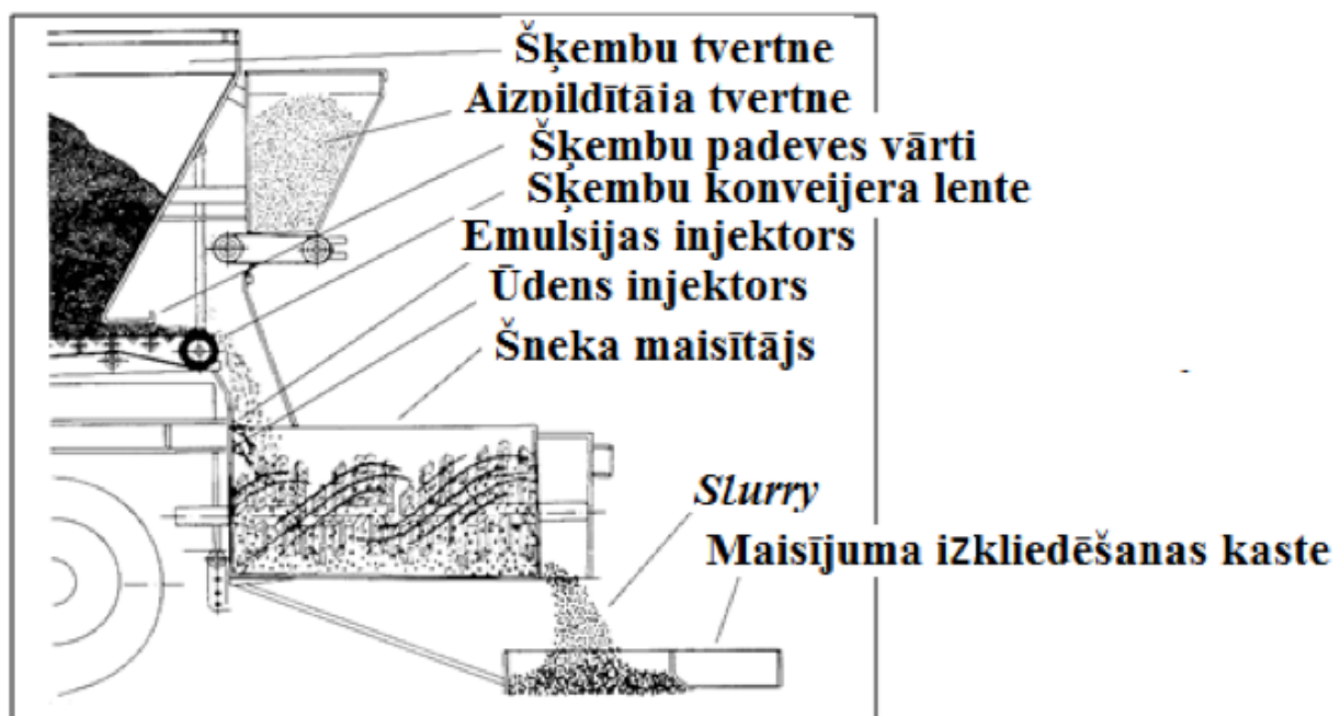
2.32.att. Slurry seal ieklājēja shēma [25]
