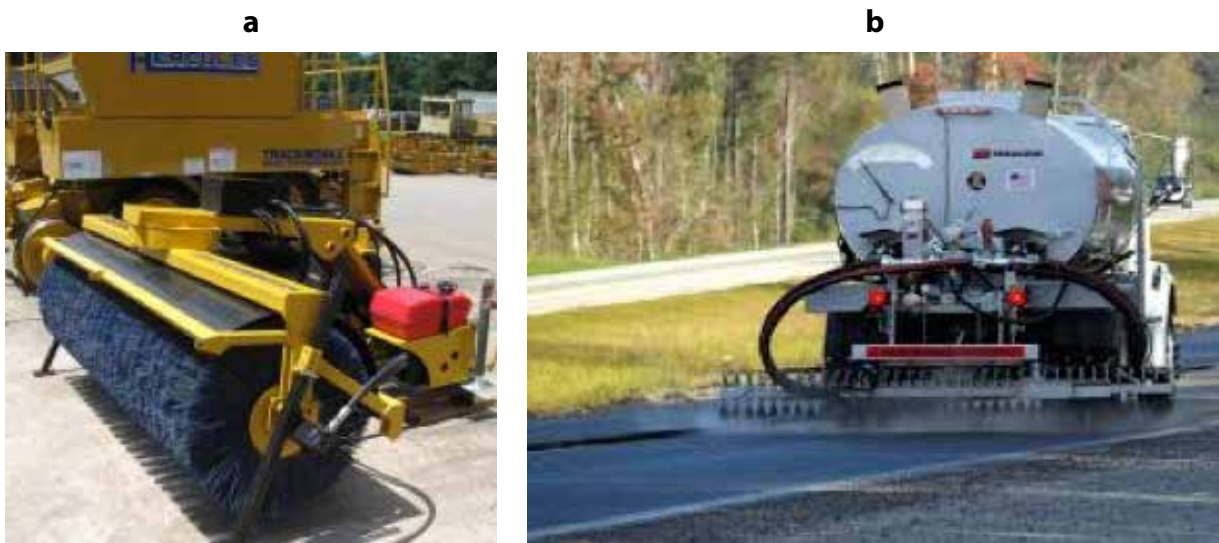
2.22.att. Mehāniskā slotā (a) un emulsijas izsmidzinātājs (b) [19]
