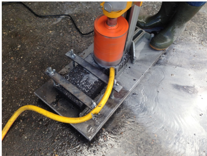
Ilustrācija 29. Puscilindra lieces testa paraugu urbšana
