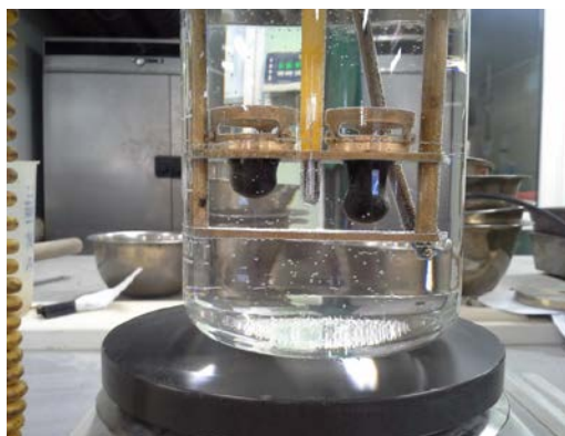
Ilustrācija 55. Mīkstēšanas temperatūras noteikšana
