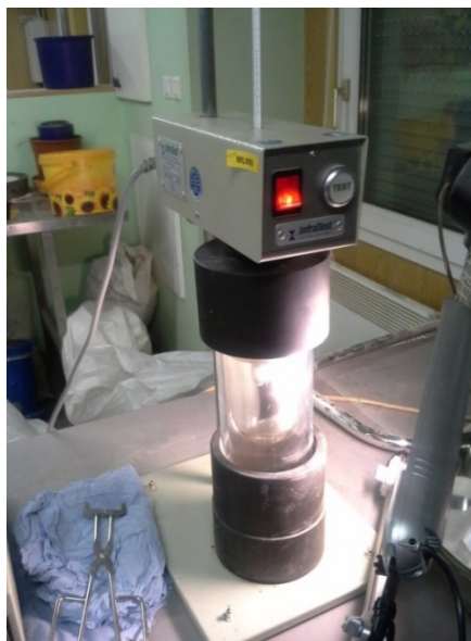
Ilustrācija 21. Fraasa trausluma temperatūras noteikšana
