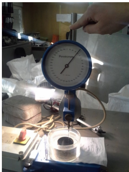
Ilustrācija 19. Bitumena penetrācijas noteikšana ar penetrometru
