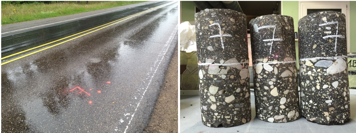
Ilustrācija 16. Paraugu urbšanas vietas un izurbtais paraugs pirms sazāģēšanas
