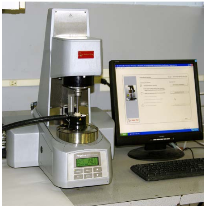
Ilustrācija 57. Performance Grade noteikšana (DSR iekārta)
