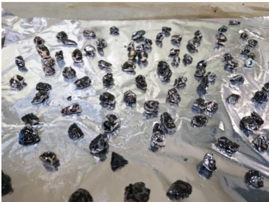
5-2 . attēls. Minerālmateriālu un saistvielas sasaiste saskaņā ar LVS EN 12697-11 5.p. - BITUMAX
