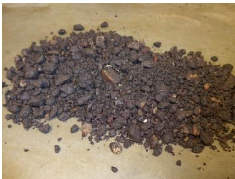
5-3 . attēls. Aukstais bituminētais maisījums SMART ASFALT
