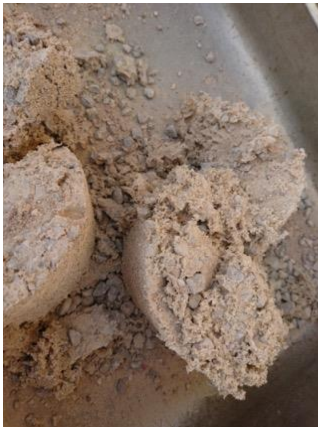
5-8 . attēls. Technisoil-G5 ar slapjiem minerālmateriāliem pēc spiedes stiprības testēšanas (materiāls kā "švamme", izskatās, ka ūdens atgrūž saistvielu un neļauj sasaistīties ar minerālmateriālu)
