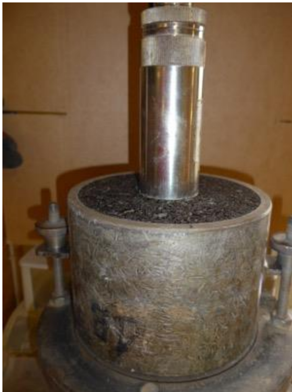
5-7 . attēls. Ar Proktoru sagatavota aukstā bituminētā maisījuma parauga Tūlītējā nestspējas indeksa testēšana
