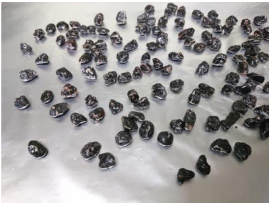
5-1 . attēls. Minerālmateriālu un saistvielas sasaiste saskaņā ar LVS EN 12697-11 5.p. - IGATE
