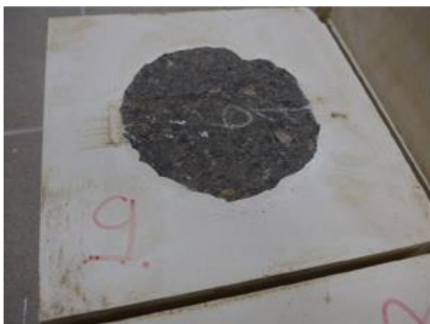
7-51 . attēls. Urbtie paraugi pēc riteņu sliežu testa veikšanas
