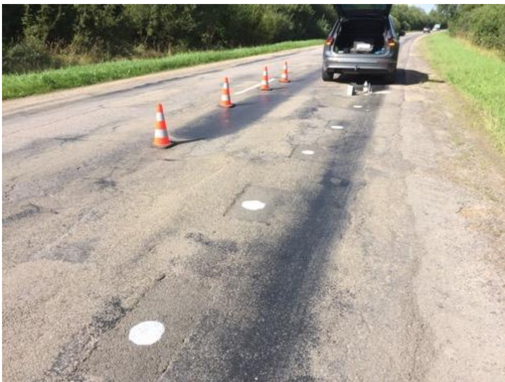
7-49 . attēls. Makrotekstūras uzmērīšana 2. posmā km 1,070 – 1,025, kreisā josla
