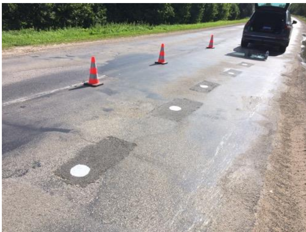
7-48. attēls. Makrotekstūras uzmērīšana 1. posmā km 0,350 – 0,395, labā josla
