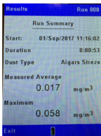
5-10 . attēls. Mērījuma atskaides piemērs iekārtas displejā
