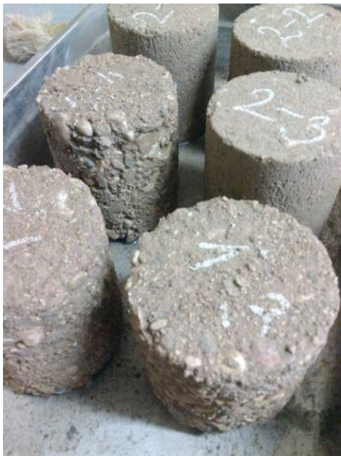
4-1 . attēls. Smilts-grants maisījums no atradnes "Ceļinieki" ar cementu pēc 7 dienu cietēšanas un 24 h mērcēšanas ūdenī, pirms spiedes stiprības testēšanas
