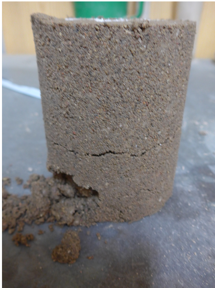
4-2 . attēls. Materiāla no atradnes "Elerne" maisījums ar kaļķi pie vai tūlīt pēc atveidošanas sabrūk
