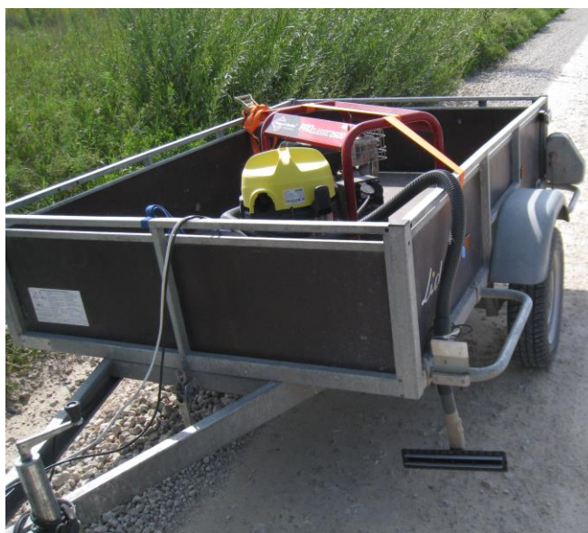
Nokomplektēta putekļu daudzuma mērīšanas iekārta a/m piekabē (putekļu sūcējs, generators, putekļu iesūkšanas atvere)
