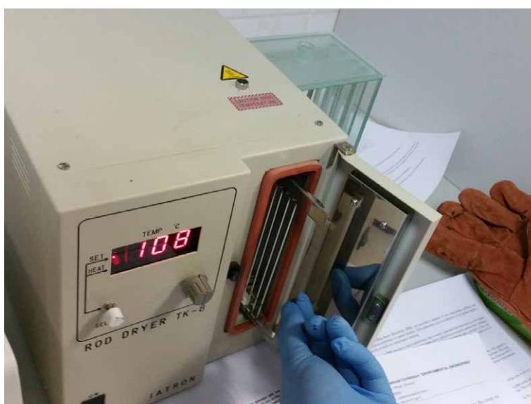
27. att. Hromatogrāfa stieņu ievietošana krāsnī
