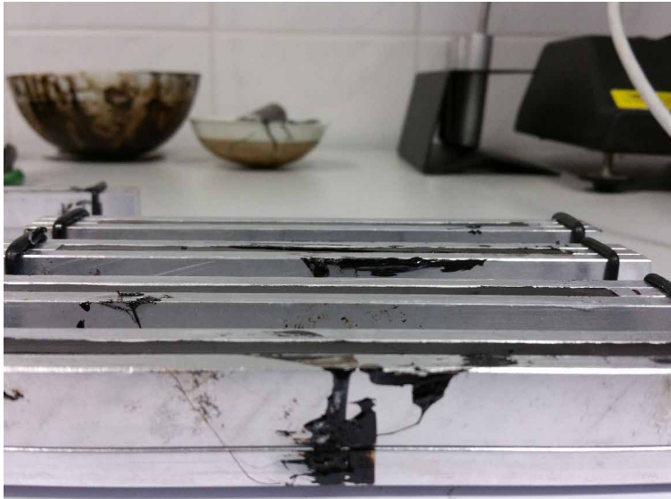
46. att. Paraugi pēc liekā bitumena nogriešanas
