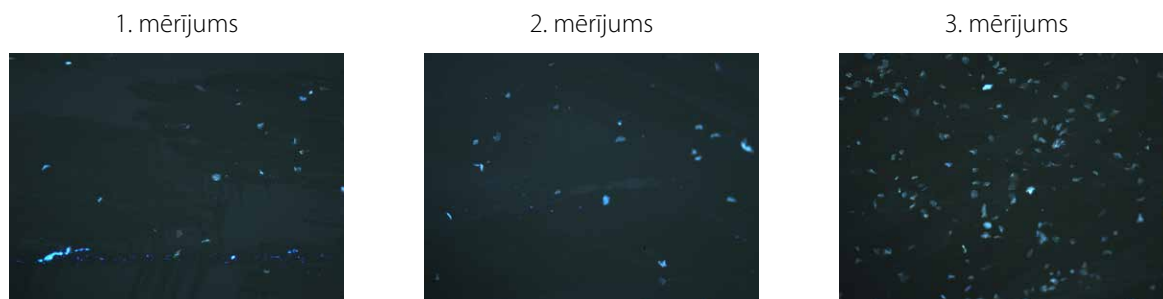
35. att. Bitumena B70/100 + 2,5%SBS (R30) izgatavota laboratorijā fluorescences mikroskopijas mērījumi ar palielinājumu x 100.
