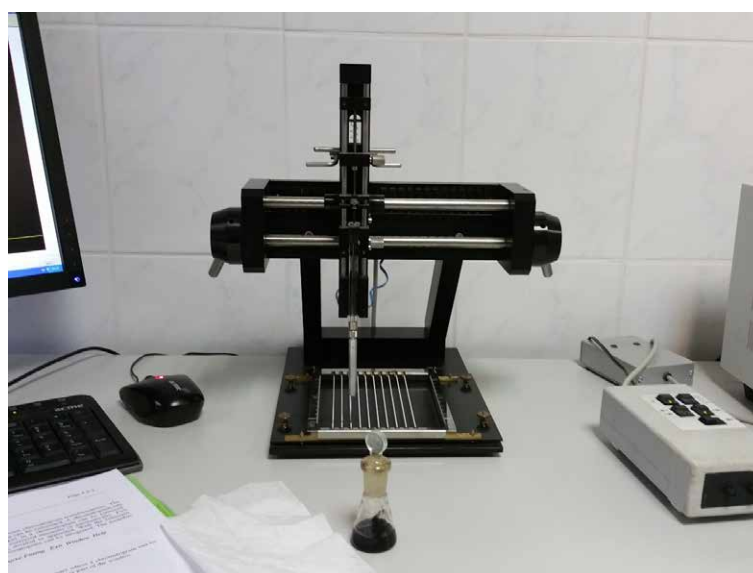
25. att. Parauga uzklāšana uz hromatogrāfa stieņiem
