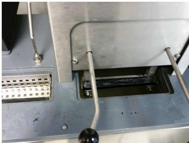
48. att. Paraugs novietots uz balstiem
