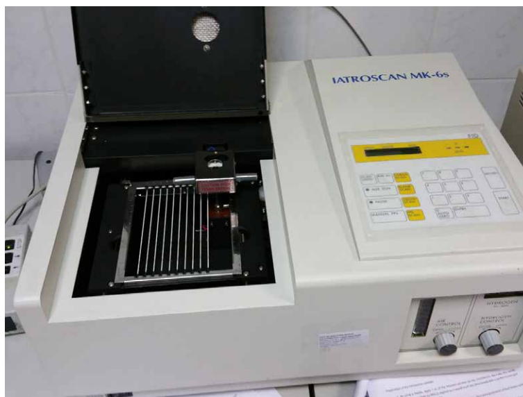
28. att. Paraugs sagatavots hromatogrāfijai
