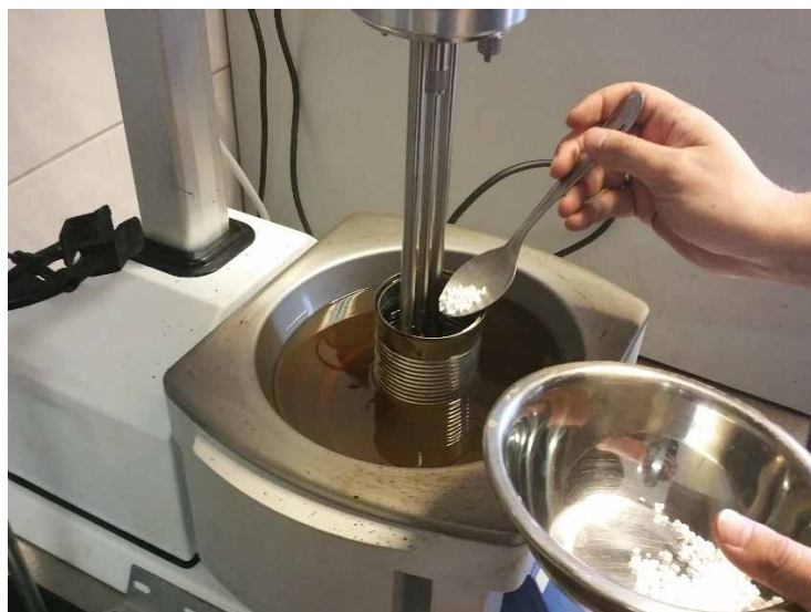
31. att. PMB bitumena izgatavošana laboratorijā
