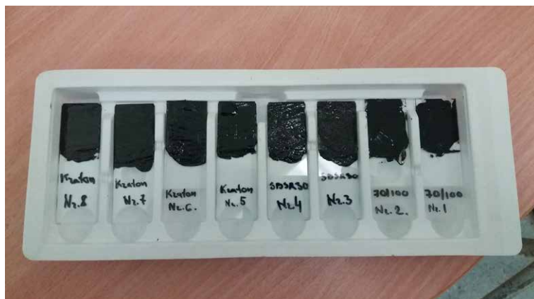
32. att. Bitumena paraugi Fluorescences mikroskopijas testiem
