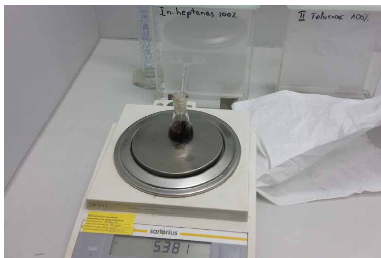
24. att. Izšķīdināts bitumena paraugs
