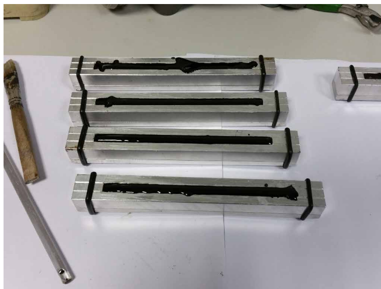
45. att. Ar bitumenu piepildītas veidnes
