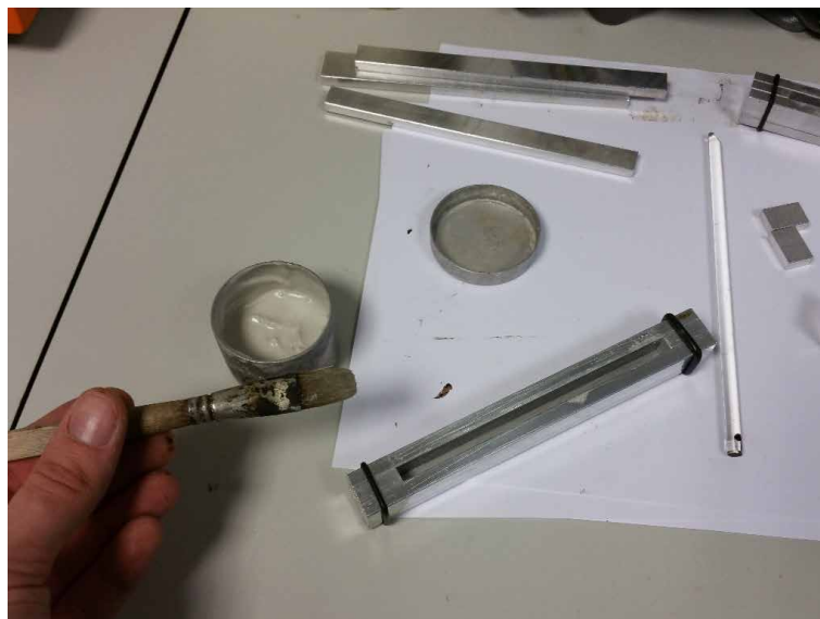
44. att. Veidnes sagatavošana BBR testam
