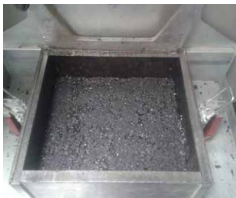
4.6. att. Uzformēta AC22 apakškārta
