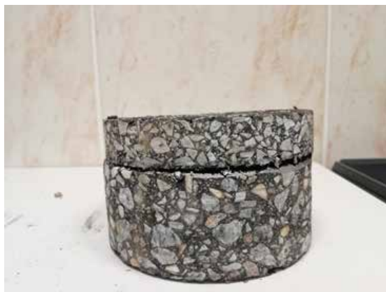
4.9. att. Paraugs, testēts uz starpslāņu bīdi
