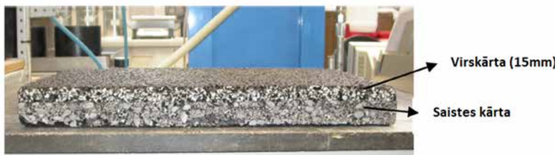
9.6. att. Divslāņu testa plāksne ar AC 14 saistkārtu un RUMG 6.3 virskārtu [4]
