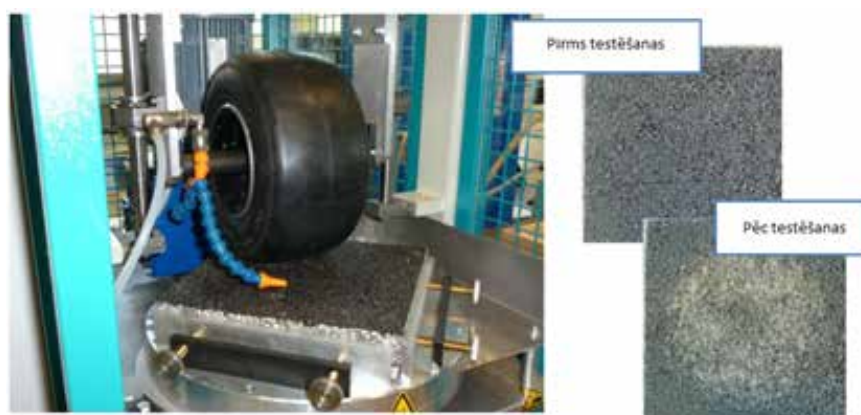
9.3. att. Darmstadt Scuffing Device (DSD) un testa paraugi [4]
