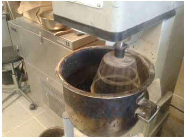
4.3. att. Asfaltbetona maisīšanas iekārta BM 20
