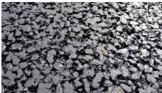
8.3. att. Jauna SMA seguma tuvplāns ar ļoti vienmērīgu virsmas tekstūru, kas samazina vibrāciju radīto troksni. Seguma virsmā redzamas atvērtas poras, kas palīdz samazināt troksni, ko rada gaisa pumpēšanas efekts
