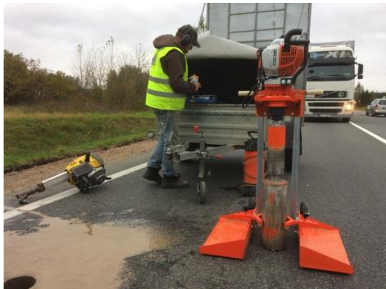
2-1. attēls. Paraugu ņemšanas urbis ar pagarinājumu
