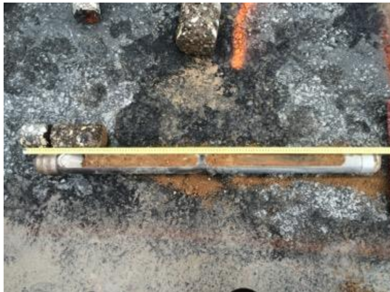
2-9. attēls. Iedzītās paraugu ņemšanas caurules izvilkšana
