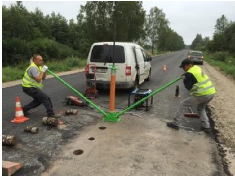
2-9. attēls. Iedzītās paraugu ņemšanas caurules izvilkšana
