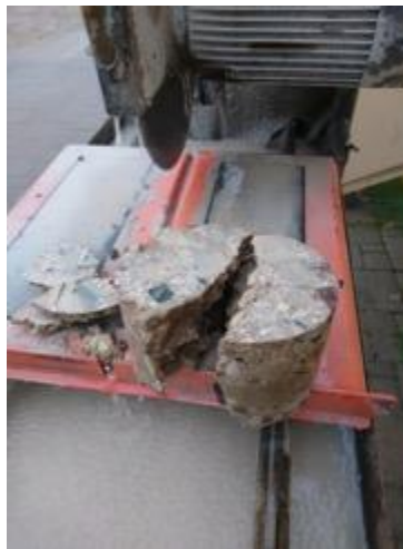
2-6. attēls. Sabrucis izurbtais paraugs
