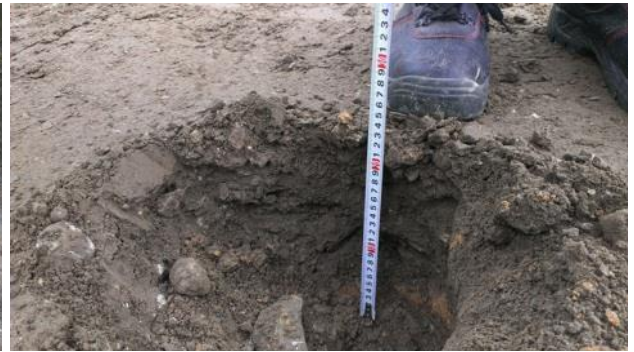
6-18 attēls. Šurfēšana un reciklētās kārtas biezuma uzmērīšana
