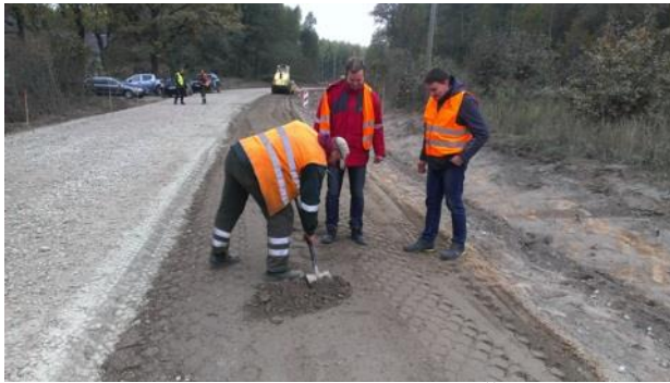
6-18 attēls. Šurfēšana un reciklētās kārtas biezuma uzmērīšana
