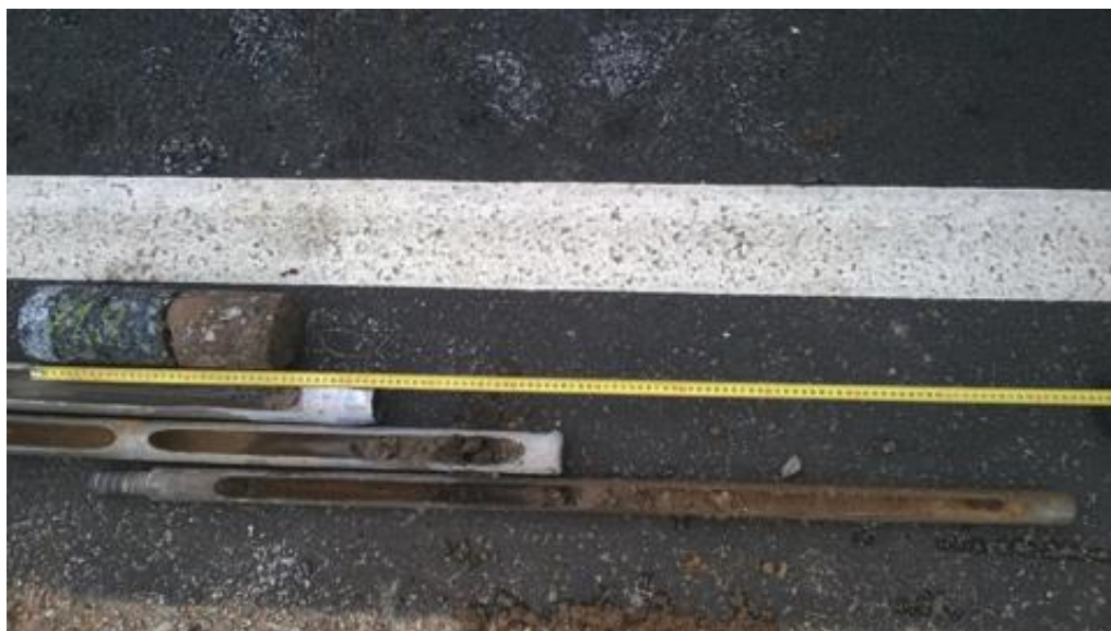
8-3 attēls. Ceļa segas konstruktīvo kārtu un zemes klātnes grunts kārtu biezumu uzmērīšana
