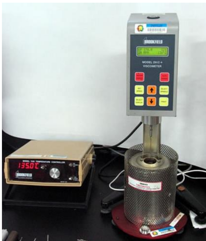
38. att. Rotācijas viskozometrs, [41]
