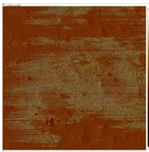
62. att. Nestabila bitumena PMB 45/80-55 struktūra a) Fāžu attēls; b) Pieskārsanas amplitūdas attēls
