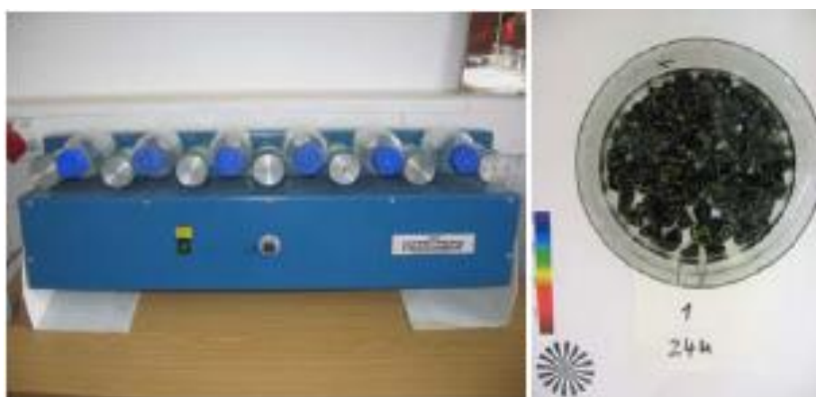
79. att. Rotējošu pudeļu tests adhēzijas starp šķembu daļiņām un bitumenu noteikšanai
