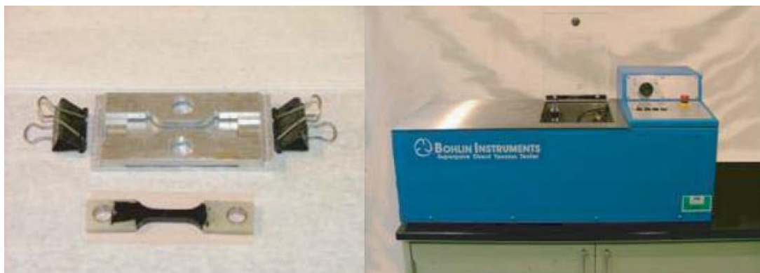
37. att. Direct tension testā izmantojamais paraugs, veidne un testēšanas iekārta [39]
