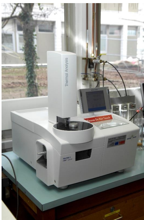
13. att. Diferenciālās skenēšanas kolorimetrijas metodes ierīce [6]
