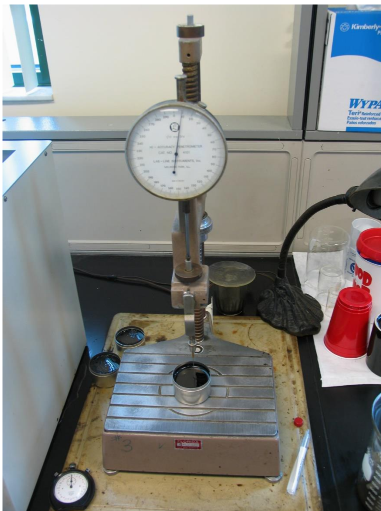
28. att. Penetrācijas testēšanas iekārta [20]
