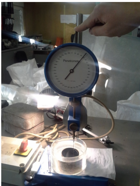
22. att. Bitumena penetrācijas noteikšana ar penetrometru
