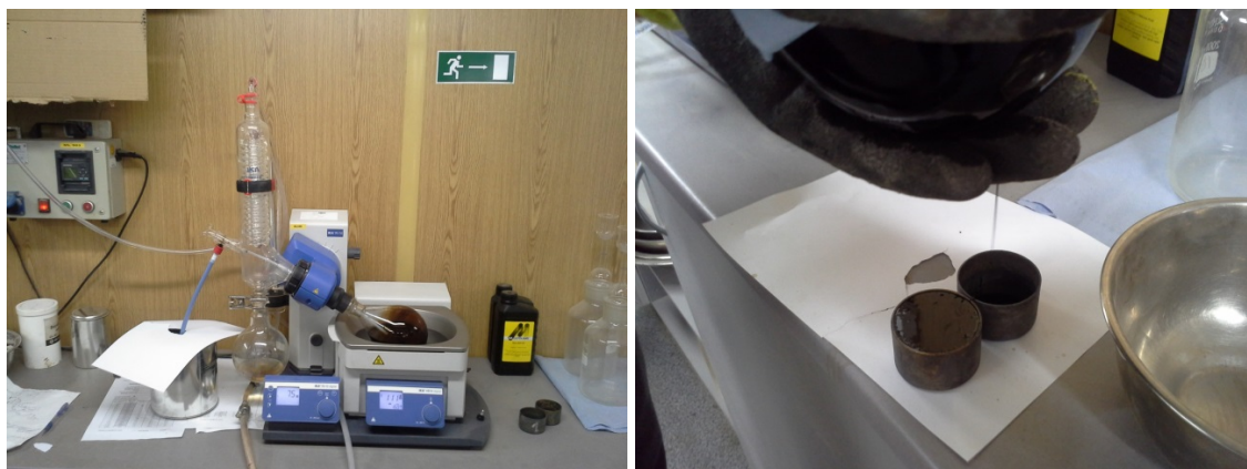
26.att. Bitumena atgūšana ar rotācijas iztvaicētāju, pēc LVS EN 12697-3
