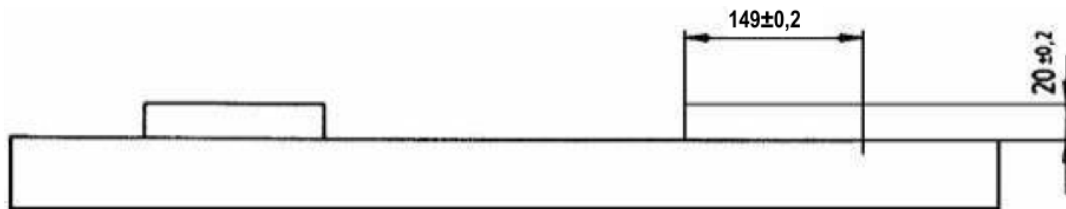
12.8-3 attēls. Plātnes shematiskais attēlojums ar uzmontētiem cilindriskiem diskam
