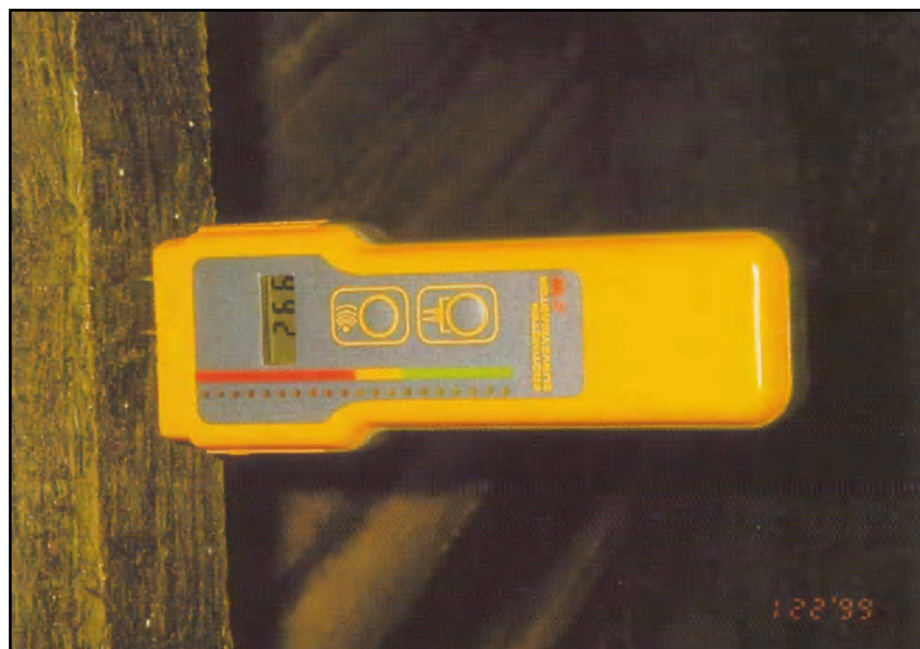
7.5.-1. att. Mitruma mērīšana kokam
