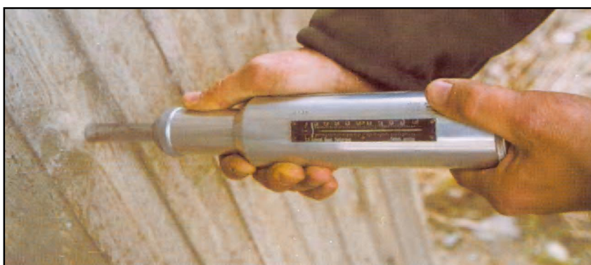
7.3.-9. att. Betona stiprības noteikšana ar atsitiena āmuru
