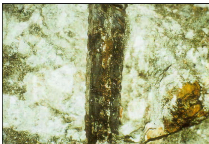
7.3.-17. att. E pakāpes korozijas piemērs
