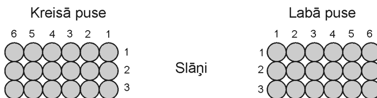
2.1.-5. att. Kabeļu kūļu numerācija iekārtiem tiltiem.
